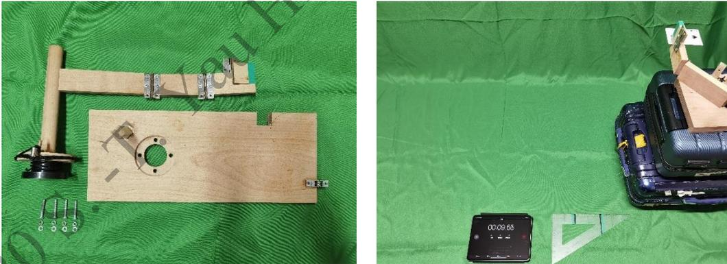
图 26 机械甩臂 ThrowArm 拆解图（左），以及实验装置搭建（右）
