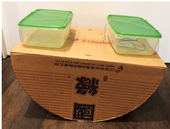
附图-2.1 (左) 2.2 (右) 采用摇摆产生动力的振动实验装置
