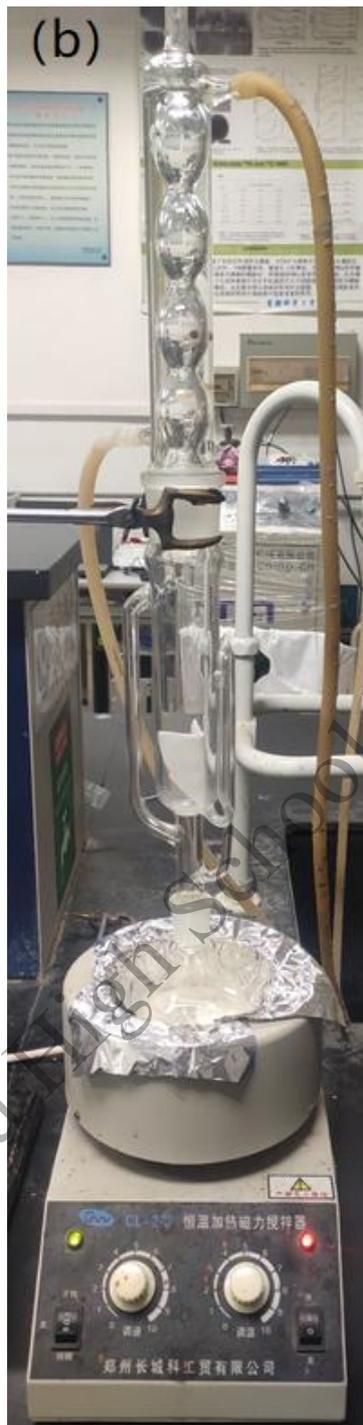
图1. 实验中所用主要设备 (a) 烘箱 (b) 索式提取器
