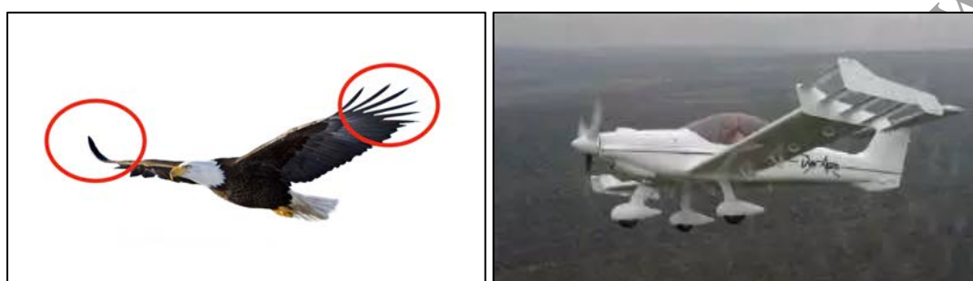
图 23 老鹰的翼尖为灵感设计了飞机的网格式翼尖小翼
