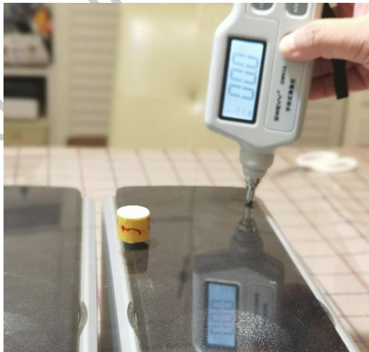
图 15 使用振动传感器测量振幅
