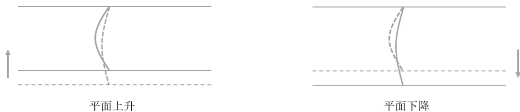
图 3 鬃毛与振动表面的相互作用机理
