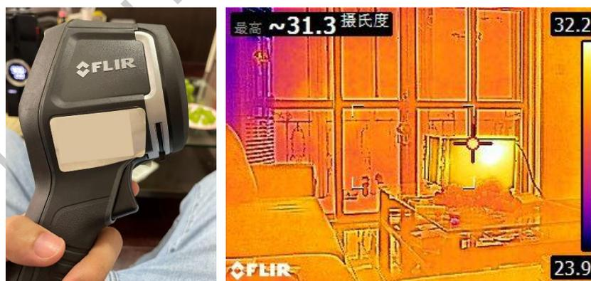
图 3.2 红外成像仪（左图），及其拍摄效果（右图）。
