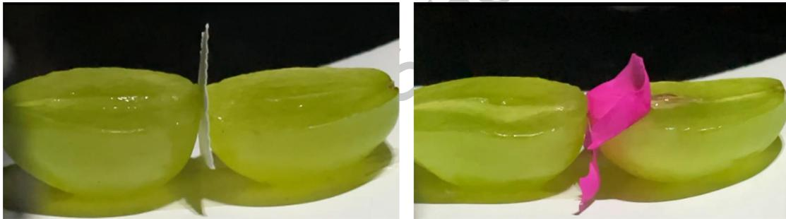
图 4.9 验证导电性实验。(左) 用导电的湿润 A4 纸隔离。(右) 用不导电橡胶隔离。
