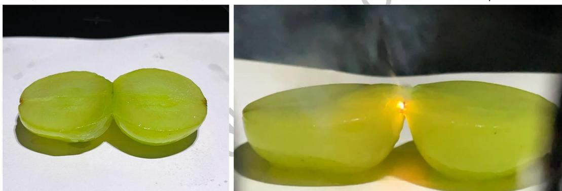
图 5.2 冰葡萄 plasma 实验。(左) 加热前与 (右) 加热中。可以观察到明显的 plasma 现象。
