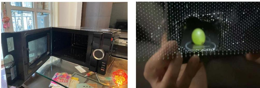
图 2.1 (左) 家用微波炉型号。(右) 微波炉改造：金属网上打孔以方便观察。
