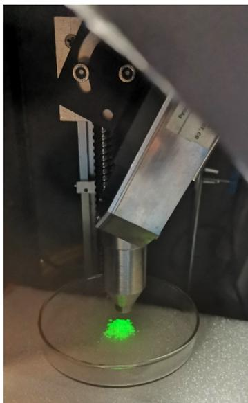
图 12. 粉末在 X 射线激发下的照片
