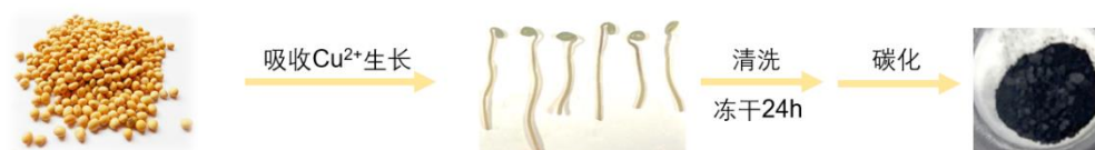
图一 材料准备和催化剂的合成
