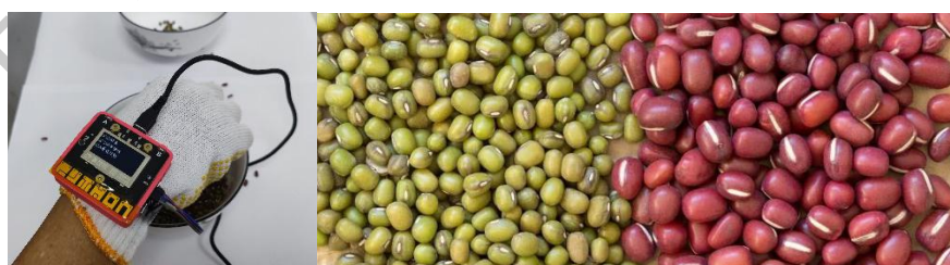
图21： 压力传感器手套，及康复训练测试分拣豆子
