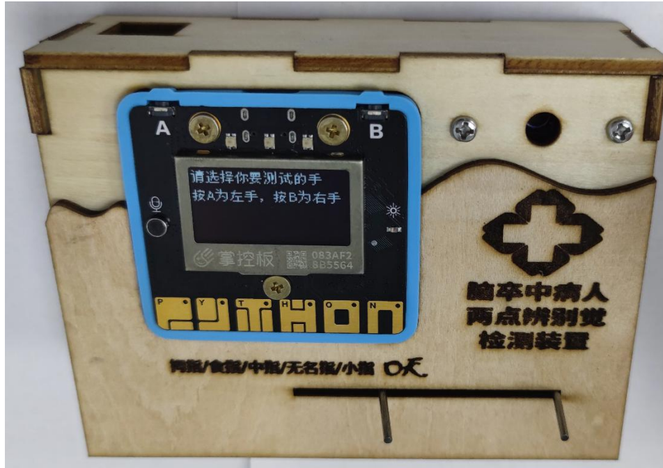
图9： 两点辨别觉检测机构原型（第二代，小型化）
