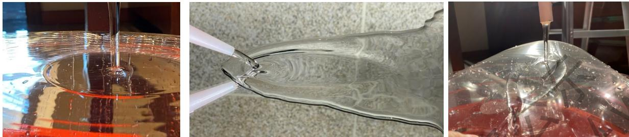
从左向右依次为水流垂直冲击亚克力板的环形水跃；水流斜射地面的鱼形水跃；水流垂直入射弯曲表面的畸变鱼形水跃
