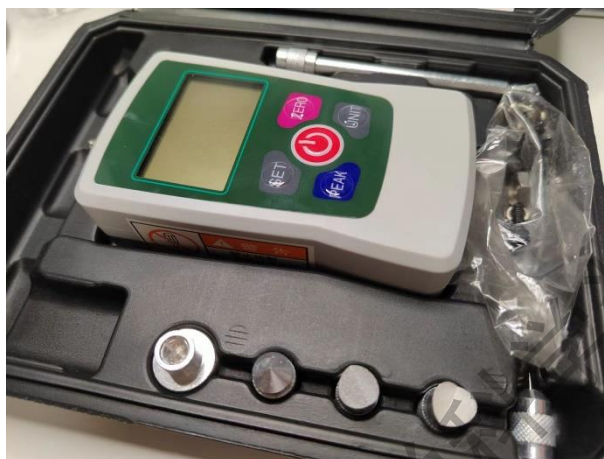
图 4.2.2 数显推拉力计与其配件（并不使用附带配件）
