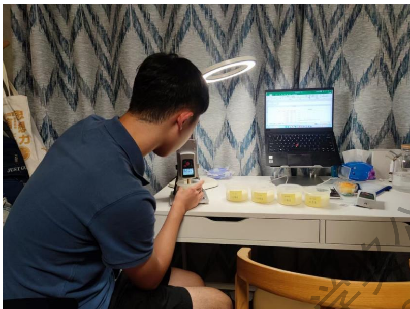
图 6.2.3 鸡蛋清固体杨氏模量的测量过程
