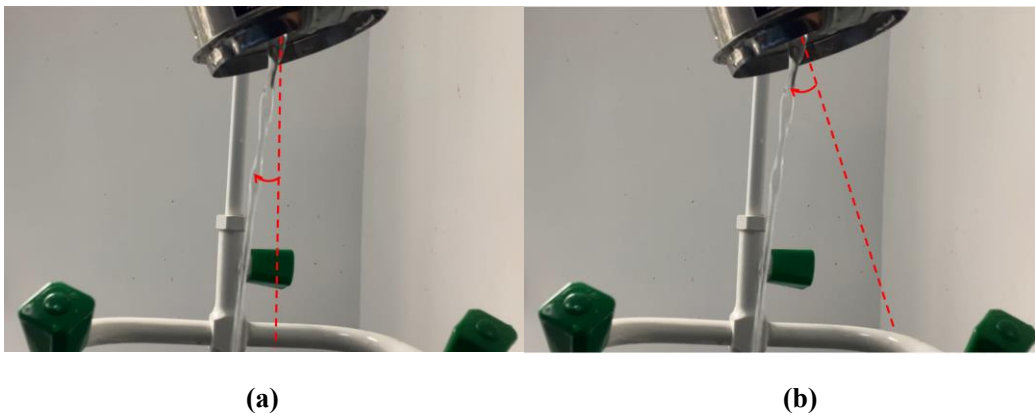
图 3 金属网体系射流折射现象。(a)展现了射流向肥皂膜偏折的现象。(b)展现了射流的出射角。
