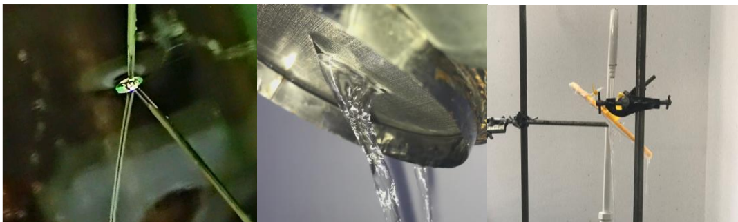
上述 3 幅图分别展示了射流在透过肥皂膜、金属网与纱布时的偏折现象
