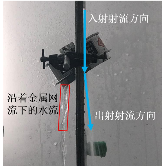
图 2 射流入射流速高于 2.5m/s 时发生的金属网体系的特殊折射现象。可见入射射流中的一部分流体沿金属网流下，另一部分汇聚为出射射流并偏向法线。
