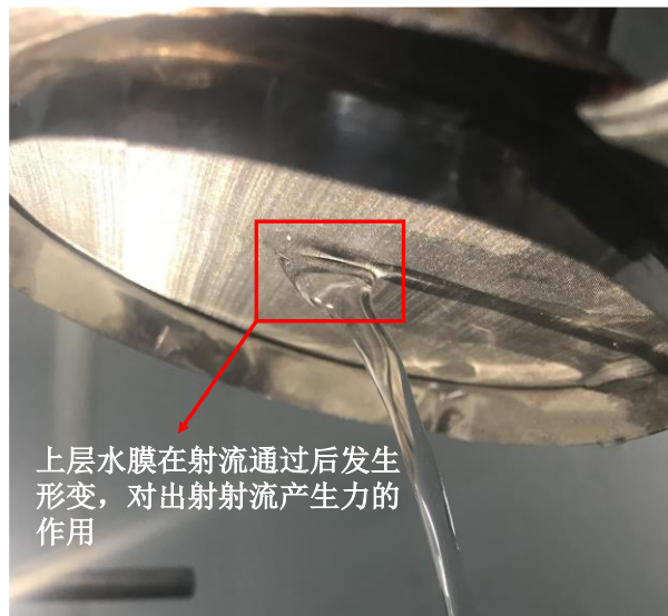
图 8 金属网体系中的水膜形变
