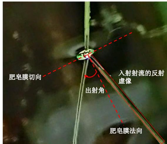
图 2 肥皂膜体系射流折射现象。可明显观察到入射射流向肥皂膜偏折，且肥皂膜产生了形变。
