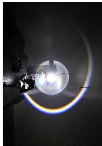
图 3.27 60° Parry 弧理论图与实验图对照
