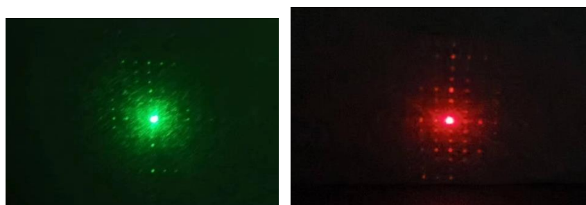
图 4. 23 激光右偏 45 度入射时 LCD 屏幕（以 iPhone 7 plus 为例）的衍射图样
