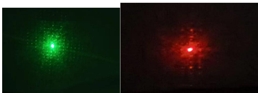
图 4. 22 激光右偏 30 度入射时 LCD 屏幕（以 iPhone 7 plus 为例）的衍射图样
