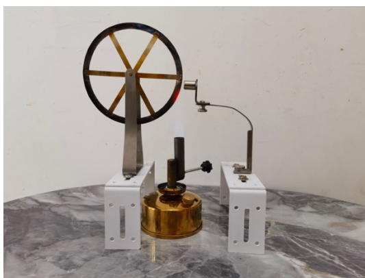
图 2a 转动式垂直居里点热机使用酒精喷灯时的实物图
