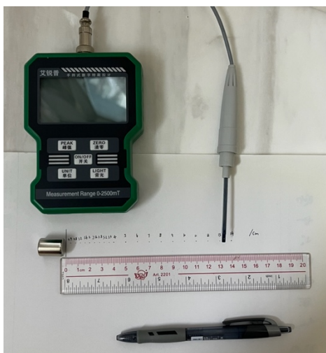
图 15a 磁场与距离关系试验仪器实物图 图 16b 磁场与距离关系试验仪器示意图
