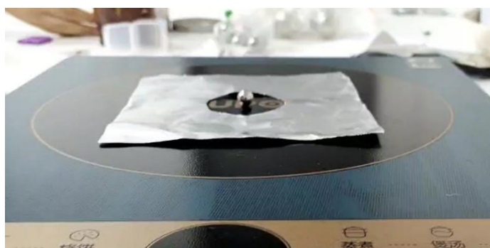
图 7.1.2 磁场中金属球与铝箔纸的运动情况
