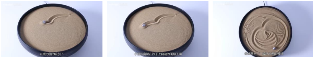
图 1.1 视频中电磁炉驱动下，金属小球自由运动，最终形成沙画的过程
