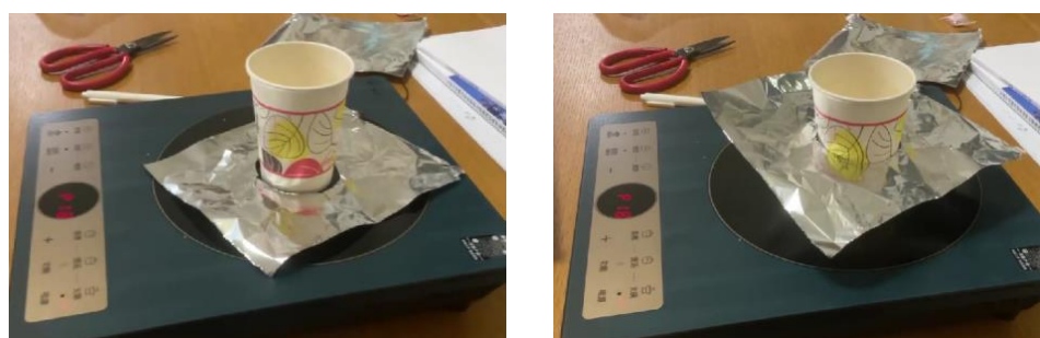
图 3.2.1 铝箔纸漂浮情况，实验时间为 0s 时（左）和为 3s 时（右）
