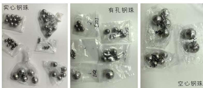
图 2.1.2 不同尺寸和不同类型的钢珠，会形成不同大小的感生电流
