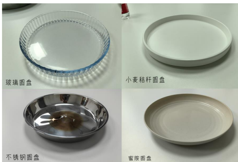
图 2.1.3 不同材质的圆盘，其具有不同的磁性，会影响交变磁场的强度
