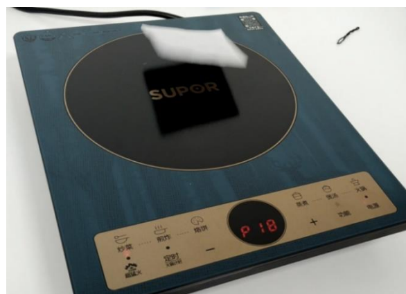
图 4.1.2 边长为 6cm 的正方形铝箔纸在电磁炉开启后，没有明显的电磁感应现象，无法在电磁炉上悬浮
