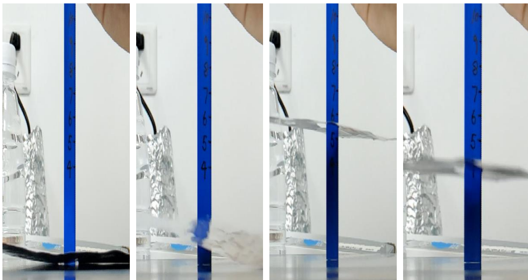
图 4.3.2 铝箔纸静止（左 1）、上升（左 2）、稳定悬浮（右 2）、下降（右 1）
