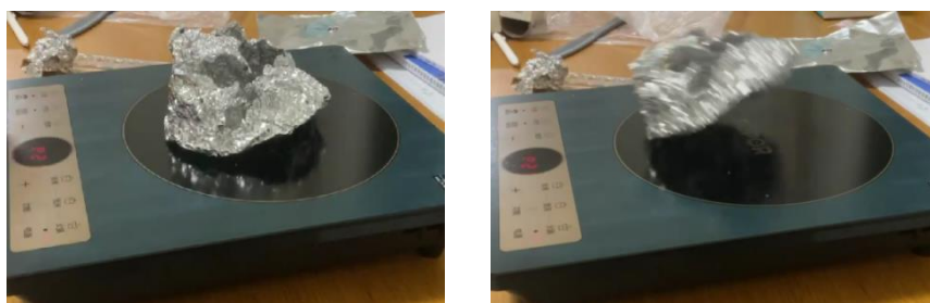
图 3.3.3 铝箔纸球处于完全压扁和原状态之间时的两种运动状态，静止（左）和运动（右）
