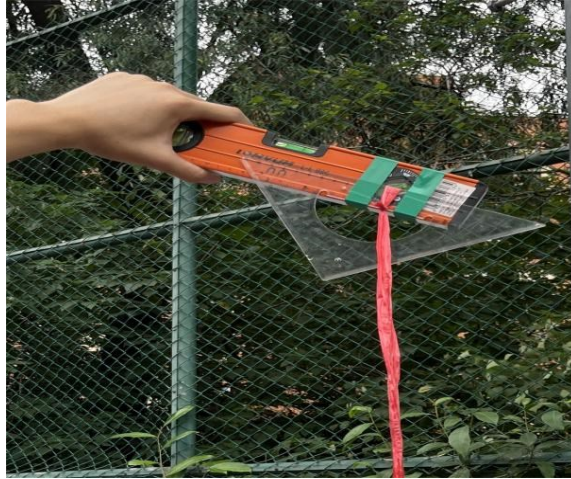
图 2.2 发射角度测量装置
