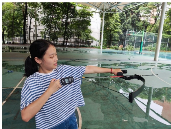
图 2.17 不同档位拉力的测量
