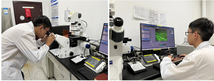
图 6 利用荧光显微镜对载药仿生皮肤进行观察
