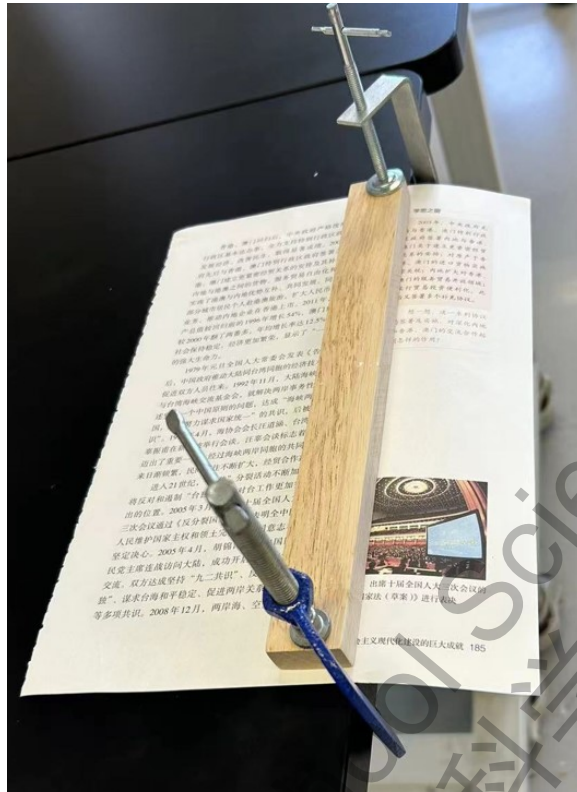
图 18: 重力效应下的纸张下垂
