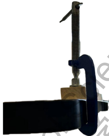
图 19: 测定 EI 的实验装置
