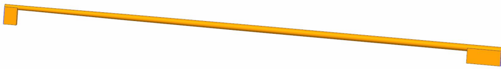
图 2.10: 琴弓的简化 3D 模型
