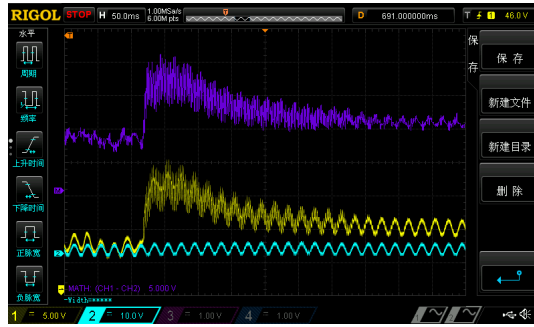
图 8: 图中紫色为测得音簧振动的数据，整体呈不规则起伏状。
