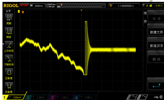
图 9: 图中振动开始时图像的顶部和底部分别有一段线段，体现了响应饱和的现象，而衰减部分则可以看出上下半明显的不对称
