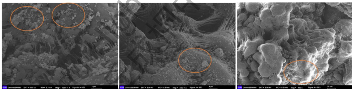
图 3-10: 吸附了磁性纳米 \gamma - \text{Fe}_2\text{O}_3 的微塑料聚乙烯 (PE) 扫描电子显微镜照片
