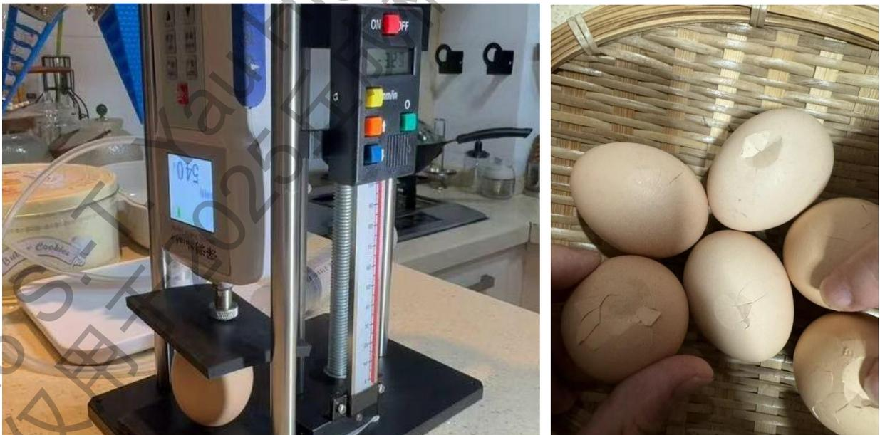
图 3.2.1 在鸡蛋壳上下表面分别加上了橡胶缓冲垫之后的实验过程记录 (左)，实验中经过测量后碎裂的部分熟鸡蛋样品 (右)
