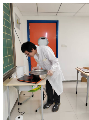
图 43 电磁炉烧开水提高水汽压
