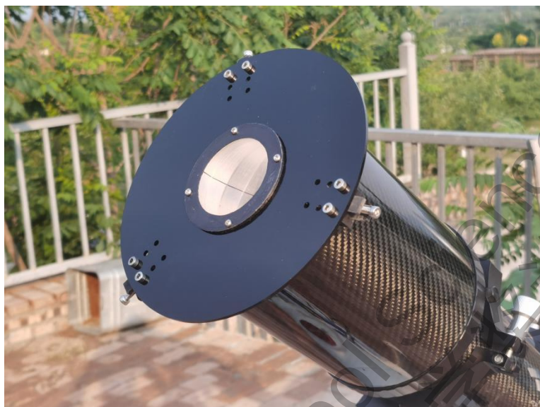
图 2-8 自制物端棱镜光谱仪效果图
