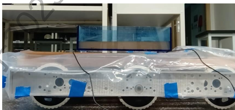
图 2：实验装置侧视图。底部：机器人底盘。（蓝色）水槽两端安置压力传感器。塑料膜是用于隔绝泼洒出的水与底部电路。
