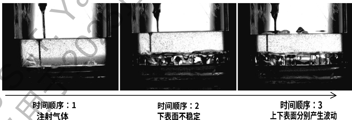
图 13: 从左至右按时间顺序依次呈现液面状态的动态演化过程，清晰展现了液体在特定条件下，从初始相对稳定的界面形态，逐步发展到最终发生失稳的复杂流体动力学现象，为研究液体界面失稳机制提供了直观且连续的视觉依据。
