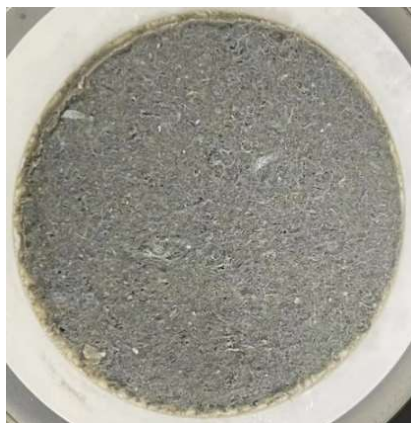
(a) NTO/Ag/g-C 3 N 4 membrane after suction-filtration (b) Dried NTO/Ag/g-C 3 N 4 membrane
