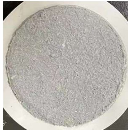
(a) NTO/Ag/g-C 3 N 4 membrane after suction-filtration (b) Dried NTO/Ag/g-C 3 N 4 membrane
