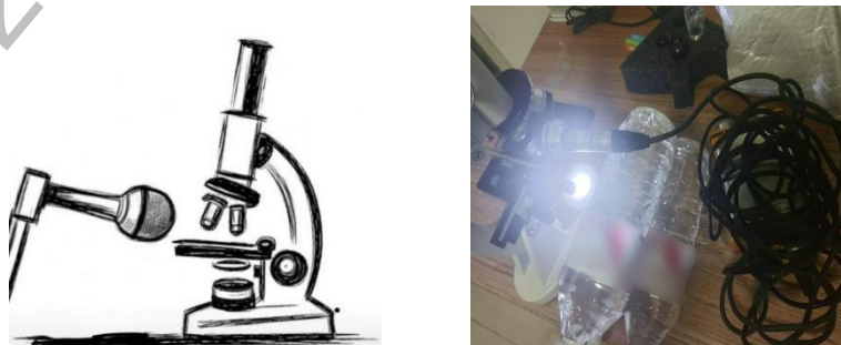
图 4-2 显微镜与超声波同时检测植物气泡状态和发声情况 实验各组结果汇总于表 4-2，具体观察现象如下：
